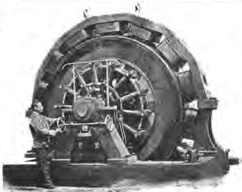
Общій видъ динамо-машины постояннаго тока въ 1000 лощ. силъ.
